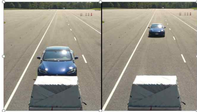
<그림 8> Tesla Model S의 ACC 미작동(AEB 만) / 작동 시 선행타겟 제동에 따른 제동모습(50km/h 속도 접근)
